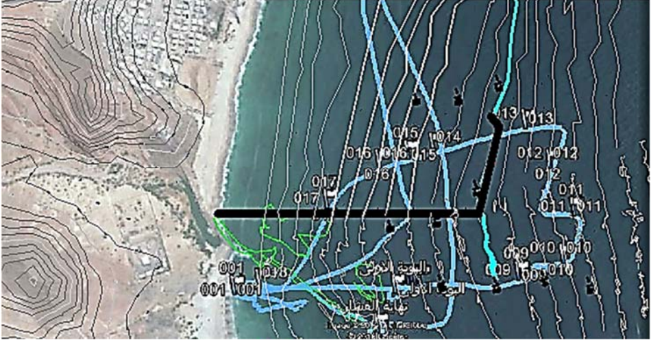
الشكل (٥) مسار المسح البحري ورصد الأعماق في موقع الرصيف وكاسر الأمواج (تقنية مسح ميداني بالسونار بتاريخ ٢٥ فبراير ٢٠١٧ - لصالح الشركة اليمنية للغاز - فرع بروم)
