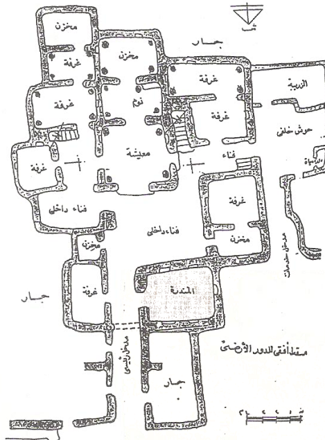
شكل رقم ( 2 ) مسقط أفقي لإحدى النماذج التقليدية للمسكن بالواحات البحرية ( مصر ) يتوسطه فناء داخلي مكشوف تحيط به الغرف
